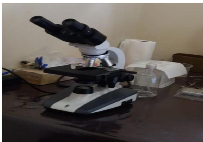
FIGURA 7 – Microscópio utilizado para as análises foi (DIGILAB MODELO DI-136B), com ZOOM ÓPTICO nas objetivas de 4x, 10x, 40x. (Realizado Aqua Nature, 2019).
